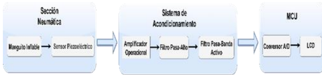
Fig.2 Bloques funcionales del canal de registro propuesto.
