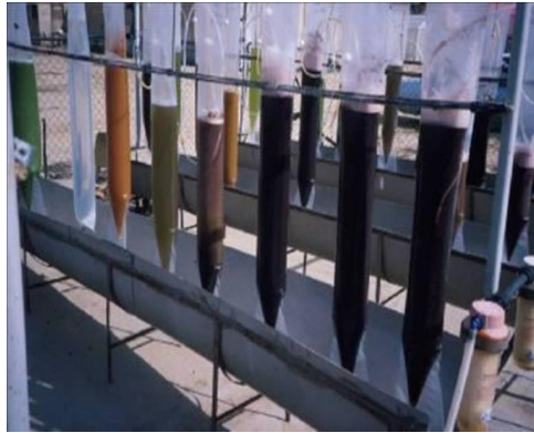
Fig.11 Reactores verticales elaborados con fundas.
