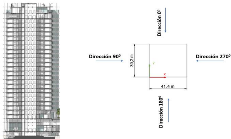
Fig.2 Vista frontal del edificio de 99 m; dimensiones, sistema de referencia y direcciones del viento analizadas
